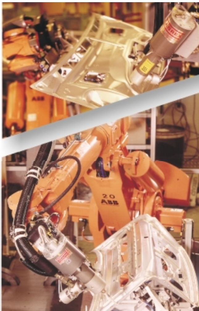
Två sätt att integrera en HD-DOSER i en robotcell, monterad på stativ (övre bilden), monterad på robot.
