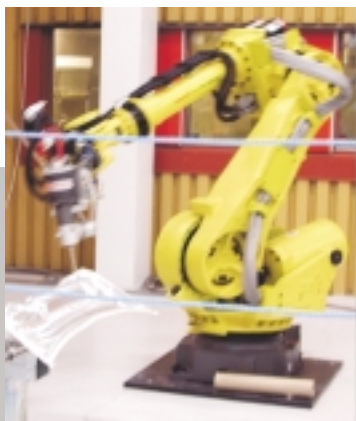
Bildserien visar en D-DOSER som efter applicering återfylls med nytt limämne i en laddstation.
