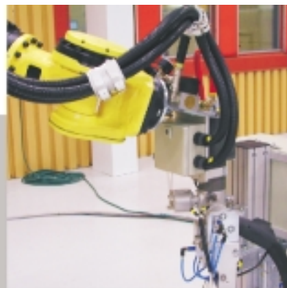
Bildserien visar en D-DOSER som efter applicering återfylls med nytt limämne i en laddstation.
