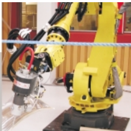
Bildserien visar en D-DOSER som efter applicering återfylls med nytt limämne i en laddstation.
