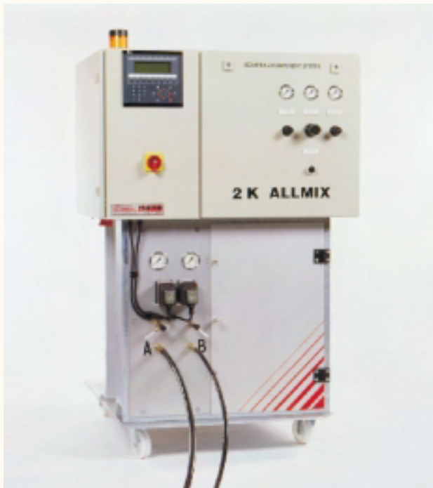
2K ALLMIX AC med PLC-styrd övervakning av blandning samt kontroll av utlagd limmängd. Maskinen används bland annat vid limning av plastfolie till förpackningsindustrin.
