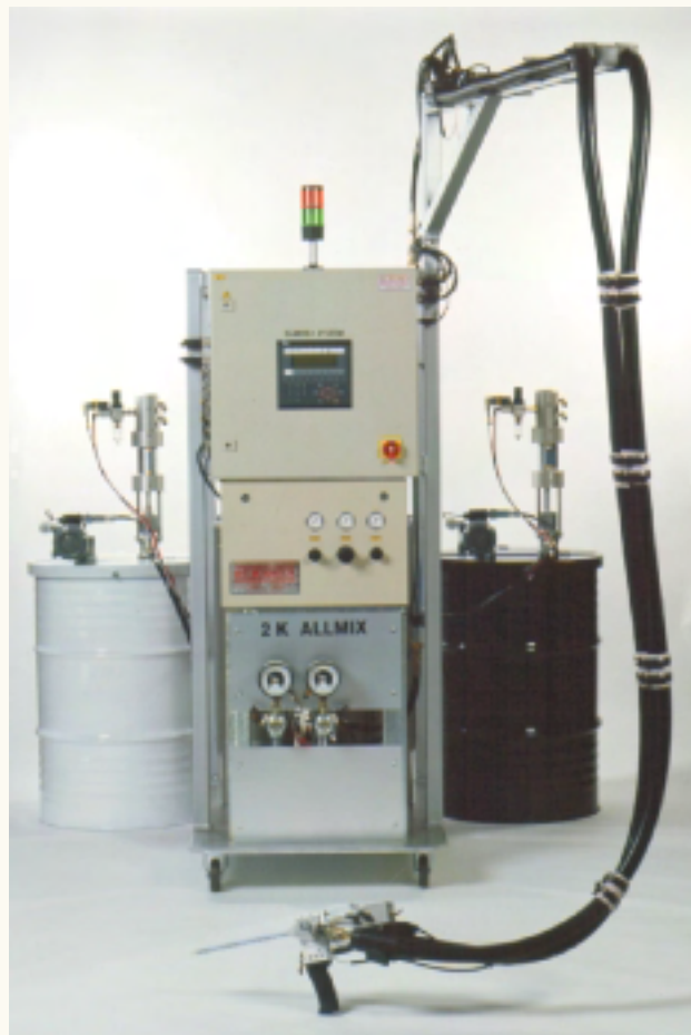
2K ALLMIX utrustad med omrörare och transportpumpar för 200 liters leveransbehållare. Uppvärmda slangar förser den statiska mixerventilen med material. PLC-styrd övervakning av blandningsförhållandet, utlagd volym, materialnivån i materialbehållarna, potliferiden samt temperaturen i systemet.
