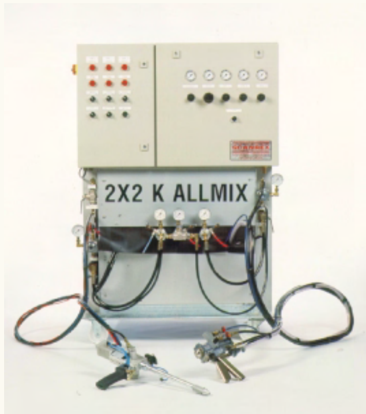
2x2K ALLMIX utrustad med två materialventiler för applicering av två olika PUR material.
